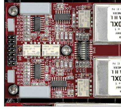
Hier ist der Eingang für MM- sowie High-Output-MC-Systeme zu sehen. In der Mitte unmittelbar bei den zwei Übertragern sitzt das "Mäuseklavier", mit dem für High-Output-MCs neben 47 kOhm auch 600 und 800 Ohm sowie 1 kOhm, 2, 3.3, 5 und 10 kOhm eingestellt werden können
