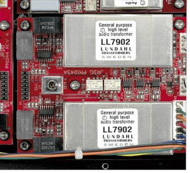
Auch bei den Ausgängen setzt Jeff Rowland auf Übertrager von Lundahl. Ein phasenlineares Subsonicfilter sorgt für die Unterdrückung unerwünschter Frequenzen. Mit dem kleinen Kippschalter in der Mitte links kann zusätzlich ein High-Pass-Filter aktiviert werden. Dieses senkt Tonarmresonanzen mit 40 dB ab, wobei aber der Einfluss auf den Frequenzgang bei 20 Hz mit -3 dB sehr gering bleibt
