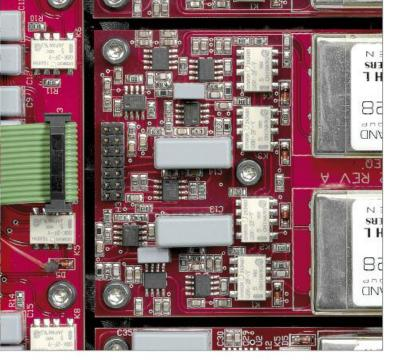
Das Equalizerboard für die MC-Eingänge wird mit Standard-Eingangsübertragern oder mit armorphen Übertragern von Lundahl angeboten. Die Standardverstärkung für MCs ab 0,2 mV beträgt 68 dB, Low-Output-Systeme können über die Option High Gain mit 74 dB verstärkt werden. Oft wird der Conductor mit einem Standard-Eingangsübertrager und einem amorphen Eingangsübertrager mit jeweils 68 dB geordert
