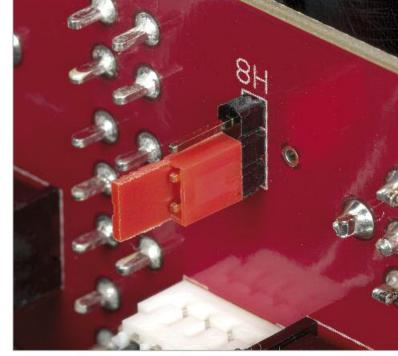
Für den Fall, dass die Signale vom Tonabnehmer an den RCA-Buchsen eines Eingangs angeschlossen werden, steht direkt an der Eingangsplatine ein Erdungsanschluss zur Verfügung. In der Regel bleibt dieser Anschluss aber offen, weil nach Ansicht von Jeff Rowland kaum einmal eine Erdung erforderlich sei. Das hat sich im Testbetrieb bei Anschluss eines Tonabnehmerkabels an den RCA-Buchsen bestätigt
